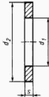
Пример условного обозначения уменьшенной шайбы для крепежной детали с диаметром резьбы 12 мм с толщиной, установленной в стандарте, из стали марки 08кп, с цинковым покрытием толщиной 6 мкм хромированным:
