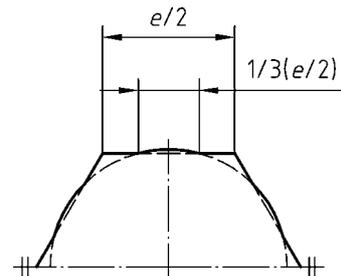
Bei gestoßenen Innensechskanten, die am oberen Grenzmaß liegen, dürfen die Schlüsselflächen höchstens über 1/3 ihrer Länge, die  $e/2$  beträgt, von der Bohrung angeschnitten werden.
