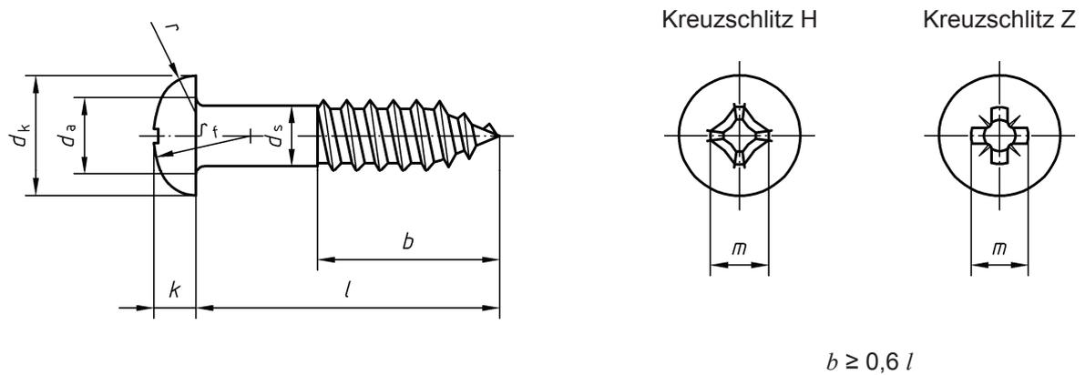
**Bild 1 — Halbrund-Holzschraube mit Kreuzschlitz**
