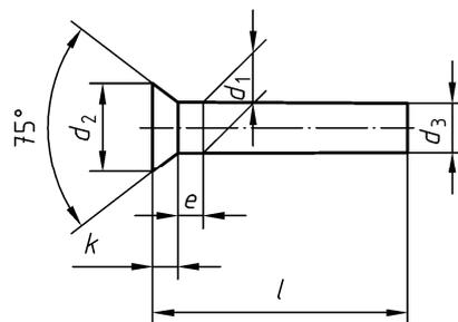
Bild 1 — Senkniete Nenndurchmesser 1 mm bis 8 mm
